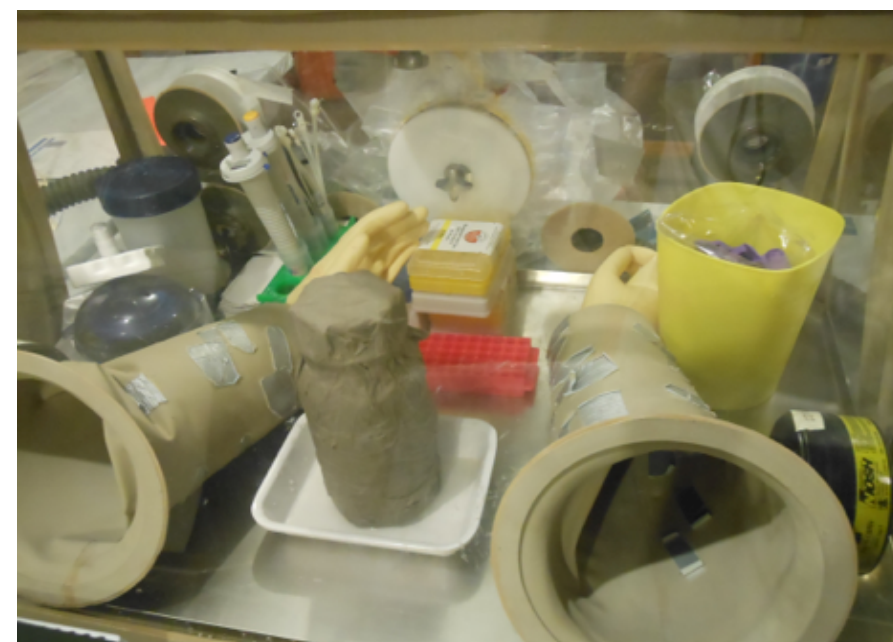
La glove box est l'outil essentiel du laboratoire permettant de manipuler les échantillons sans qu'ils n'entrent en contact avec le personnel de laboratoire ou l'air ambiant.
