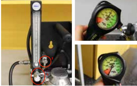
Knopf für Sauerstofffluss (1) und O<sub>2</sub>-Bypass (2)      Manometer
